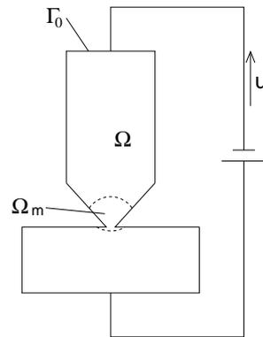
Fig. 1. Resistance stud welding
